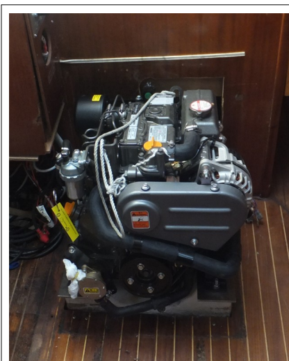
Der Motor kann für den Service vollkommen freigelegt werden. Es handelt sich beim Testboot um einen YANMAR 3YM20 mit 21PS, der über eine feste Welle einen zweiflügeligen Faltpropeller antreibt.
